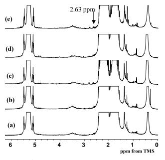
Fig. 2: <sup>1</sup>H-NMR spectra for sol fraction of (a) PC-TE, (b) RSS3-TE, (c) STR5L-TE, (d) TSS8<sup>®</sup>-TE and (e) SMR20-TE
